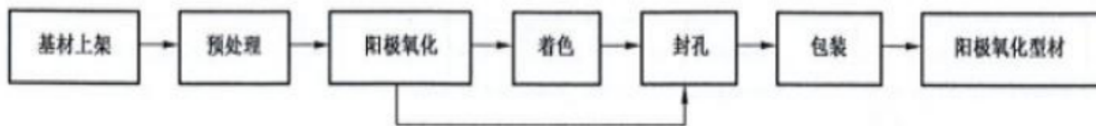
图 3.1-3 铝型材阳极氧化工艺流程图
