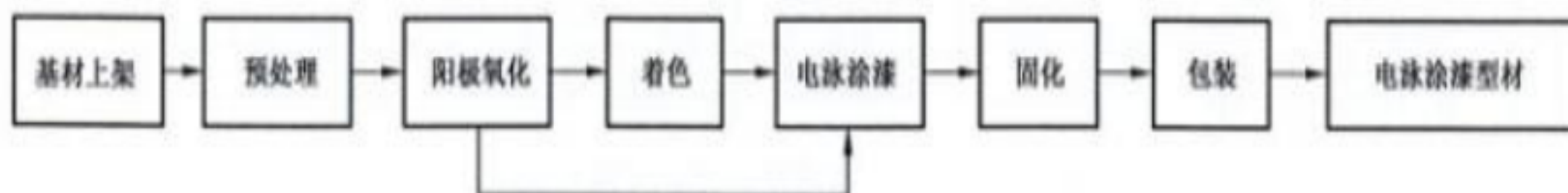
图 3.1-4 铝型材电泳涂漆工艺流程图
